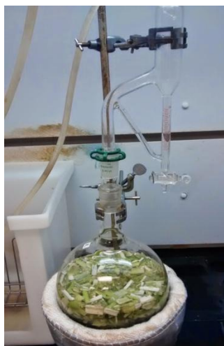
Slika 7. Aparatura po Clevenger-u
