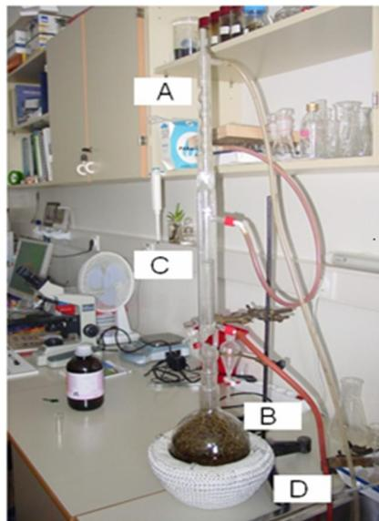
Slika 24. Aparatura po Clevenger-u; A – hladilo, B – tirkvica, C – graduirana cijev, D - kalota
