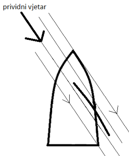
Slika 35. Preotpušteno i preotvoreno jedro ne postiže maksimalan učinak.
