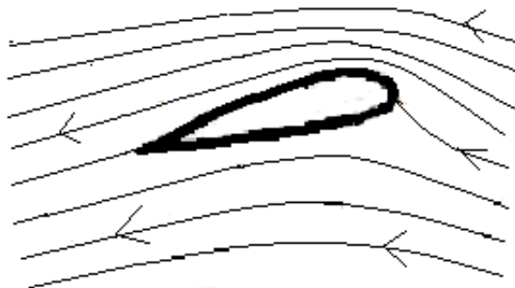
Slika 8. Zračna struja nailazi na avionsko krilo s desna na lijevo.
