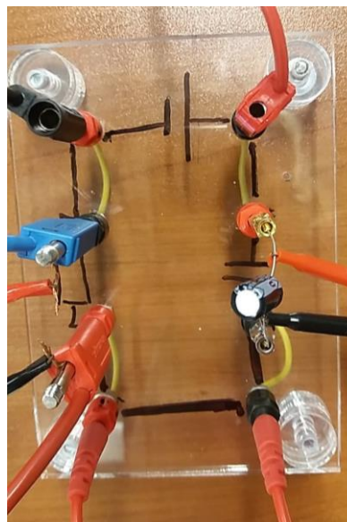
Slika 3.1.1. Shema strujnog kruga i ploča priključaka za RC krug.
