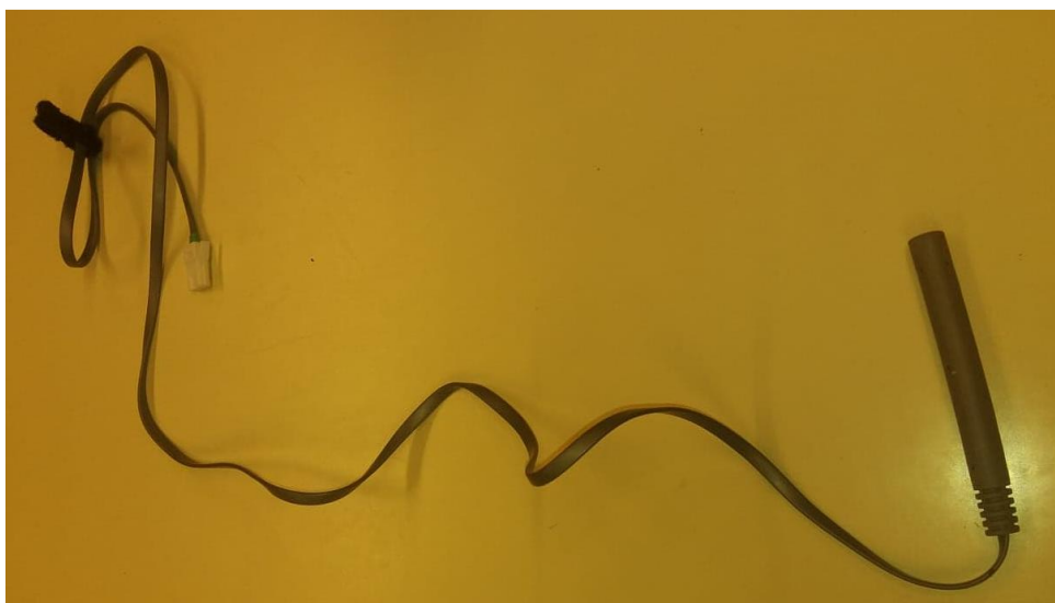
Slika 2.6. Senzor za mjerenje osvjtljenja
