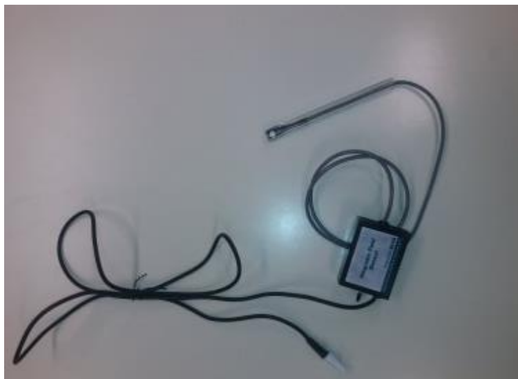
Slika 2.4. Senzor za mjerenje magnetske indukcije
