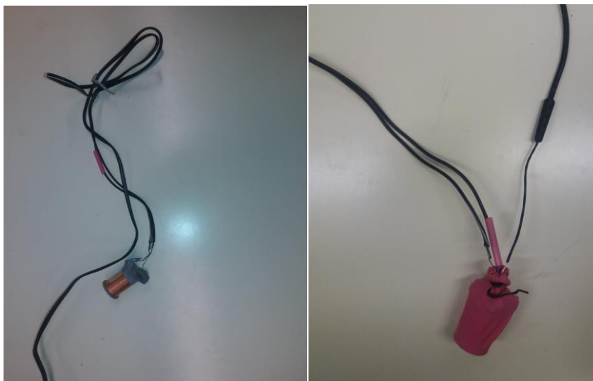
Slika 3.10.1. Otpornik od bakrene žice pripremljen je za zagrijavanje u vrućoj vodi.
