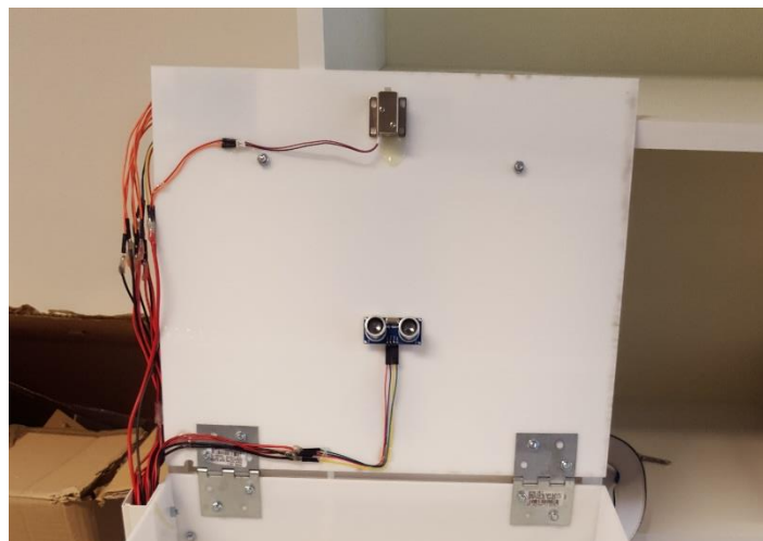
Slika 6.7. Ultrazvučni senzor na konstrukciji
