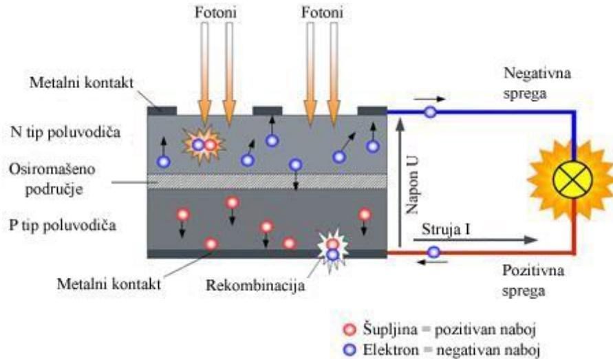
Slika 5.3. Fotonaponski efekt [22]
