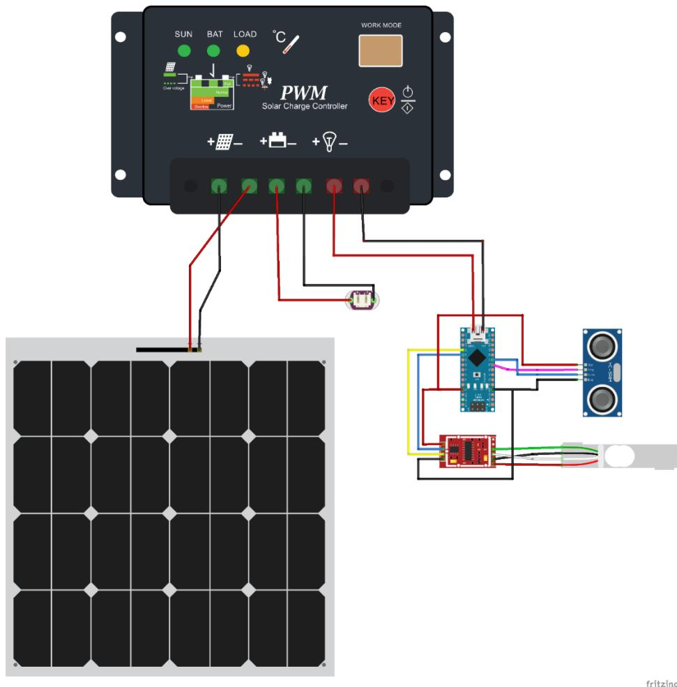
Slika 6.8. Shema spoja svih komponenti projekta sa Arduinom
