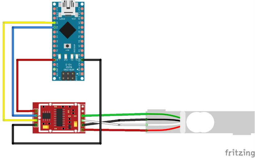
Slika 6.5. Shema spoja senzora težine, HX711 modula i Arduino Nano pločice
