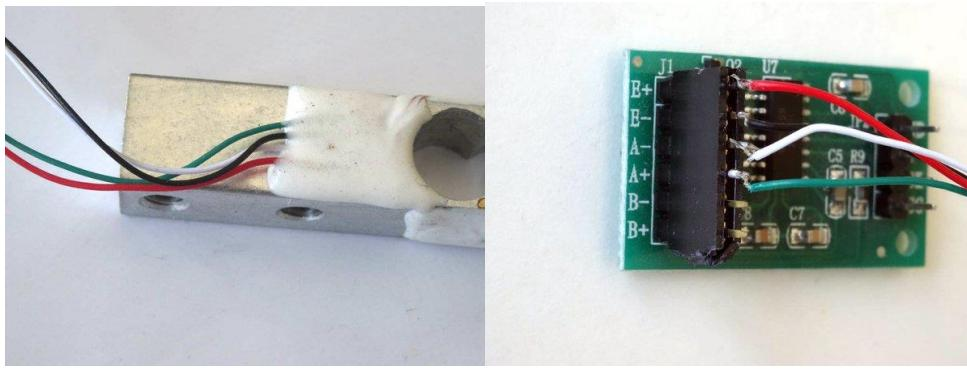
Slika 6.2. Spoj senzora težine sa HX711 modulom
