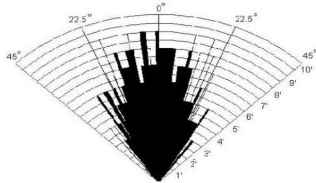
*Slika 4.3. Efektivni kut mjerena ultrazvučnog senzora[12]*
