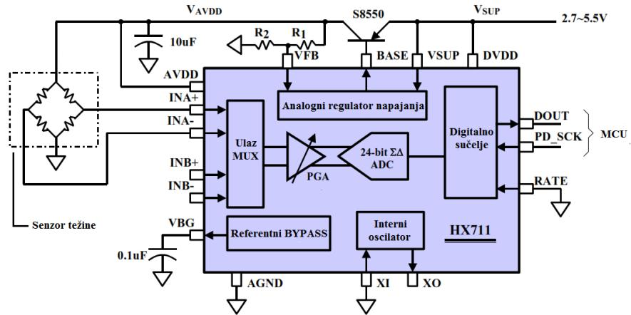
Slika 3.4. Blok dijagram spajanja senzora na HX711 [9]
