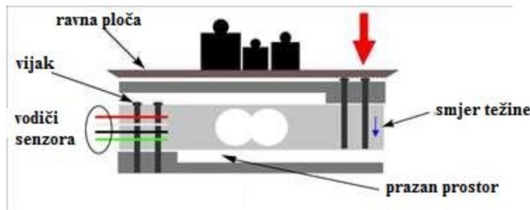
Slika 6.4. Spoj senzora težine na konstrukciju [25]
