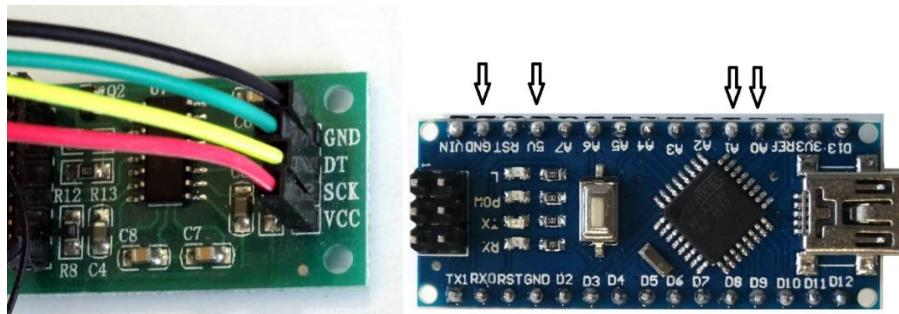
Slika 6.3. Spoj HX711 modula sa Arduino Nano pločicom
