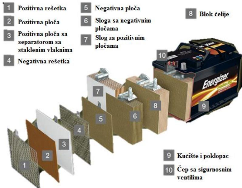
Slika 5.5. Konstrukcija AGM akumulatora [24]
