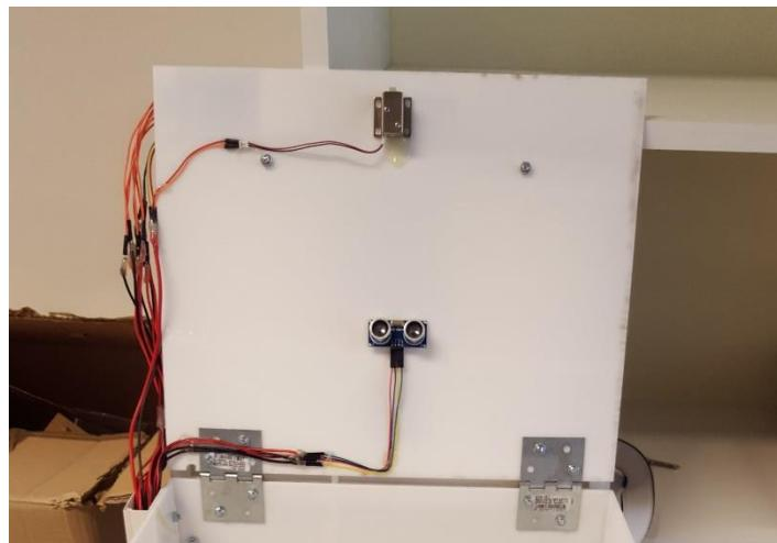
*Slika 6.7. Ultrazvučni senzor na konstrukciji*
