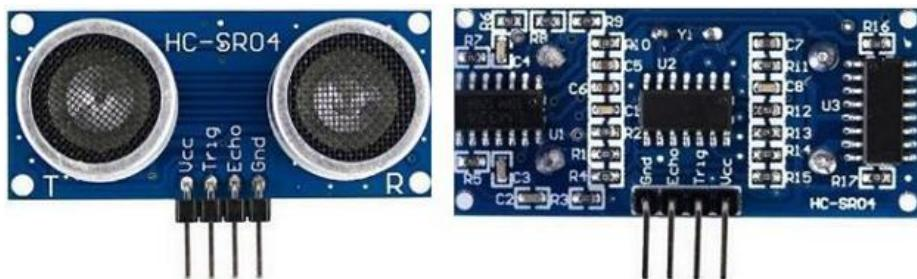
Slika 4.1. HC-SR04 ultrazvučni senzor[19]
