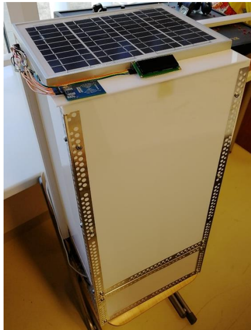
Slika 18. Izgled gotovog prototipa sa RFID sustavom za identifikaciju korisnika
