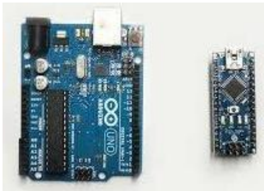
Slika 2. Usporedba veličine pločice Arduino Uno (lijevo) i Arduino Nano (desno) [21]
