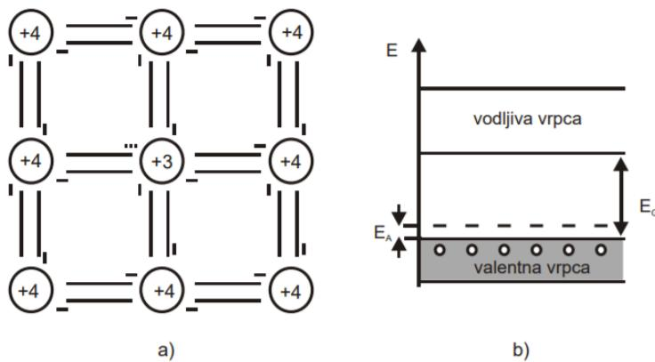
*Slika 10. a) Kristalna rešetka poluvodiča P-tipa b) Energetski dijagram poluvodiča P-tipa<sup>[18]</sup>*
