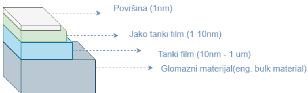
Slika 3.1. Uzorke razlikujemo po njihovoj debljini. ( po uzoru na literaturu https://xpssimplified.com/ [10])
