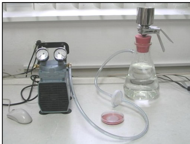
Slika 2. Uređaj za membransku filtraciju
