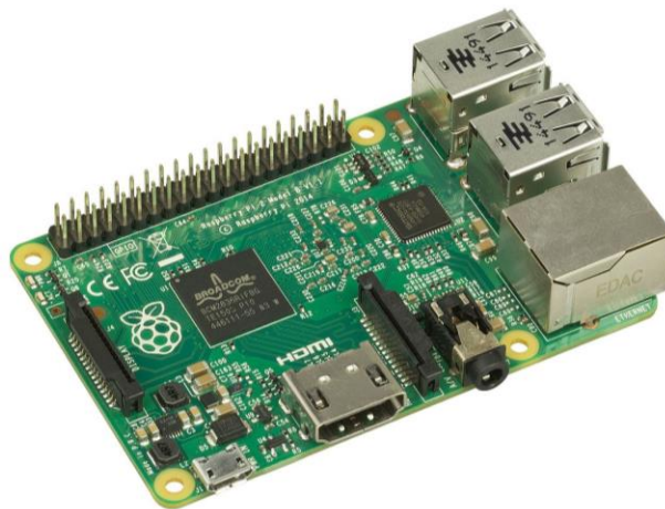
Slika 6 – mini računalo Raspberry Pi 2 model B rev. 2
