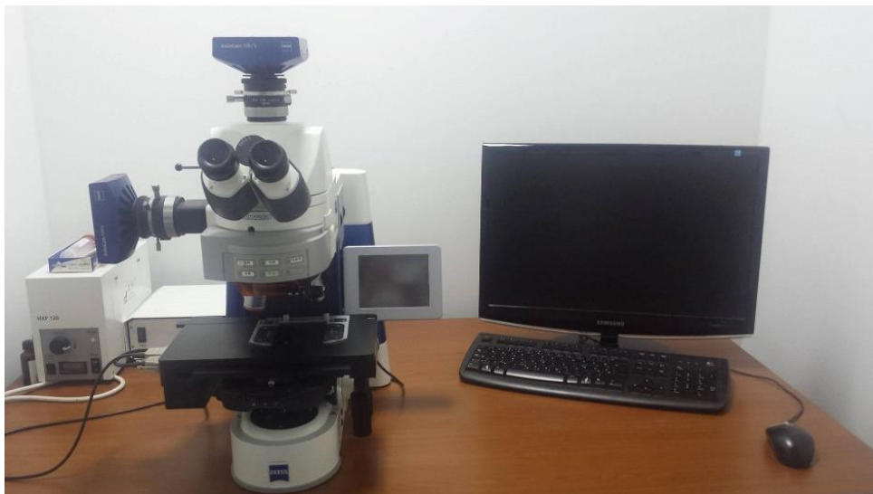
Slika 10. Fluorescencijski mikroskop s visoko rezolucijskom mikroskopskom kamerom (Carl Zeiss AxioCam MR Rev3).
