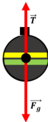
Slika 14: Dijagram sila na tijelo na niti.
