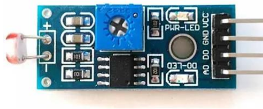
Slika 26. Izgled LM393 fotoosjetljivog modula [34]
