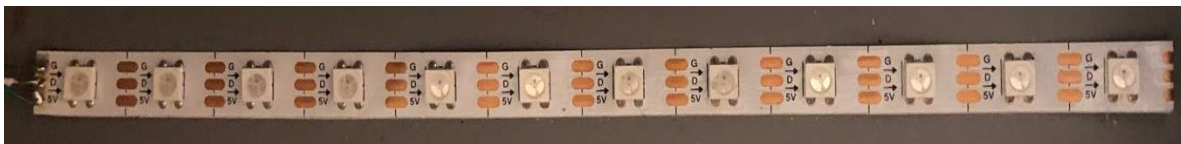
Slika 25. Izgled RGB LED WS2812B trake
