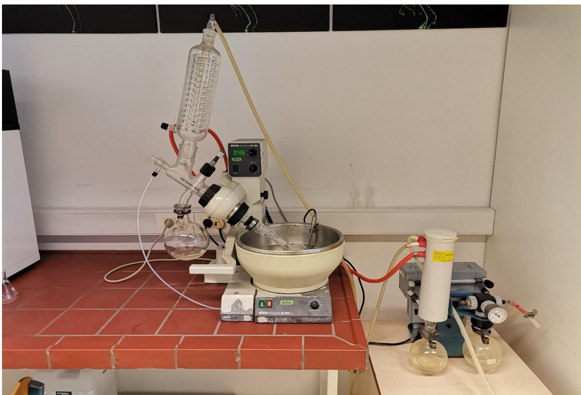
Slika 5: Uparivanje ekstrakta do suha na rotavaporu
