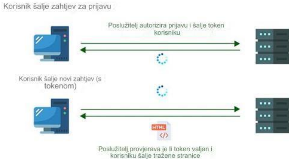
Slika 2. Autentikacija na temelju tokena (Napomena: Ovo nisu datoteke za provjeru autentičnosti, one su za autorizaciju. Dok prima token, poslužitelj ne traži tko je korisnik, on jednostavno autorizira zahtjeve korisnika oslanjajući se na valjanost tokena.)
