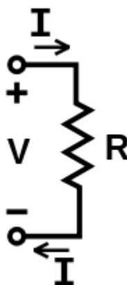
Slika 2.3. V(U) , I i R , parametri Ohmovog zakona. Struja I uslijed razlike potencijala U teče kroz otpor R . [6]
