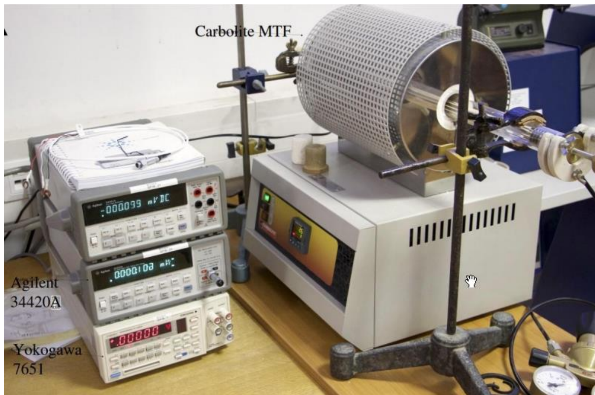
Slika 3.3. Eksperimentalni aparat; korištena je peč/temperaturni kontroler Carbolite MTF, naponski izvor/nano-voltmetar Agilent 34420A te strujni izvor – Yokogawa 7651. Uzorak se nalazi na nosaču unutar staklene cijevi te je umetnut u peč. [10]
