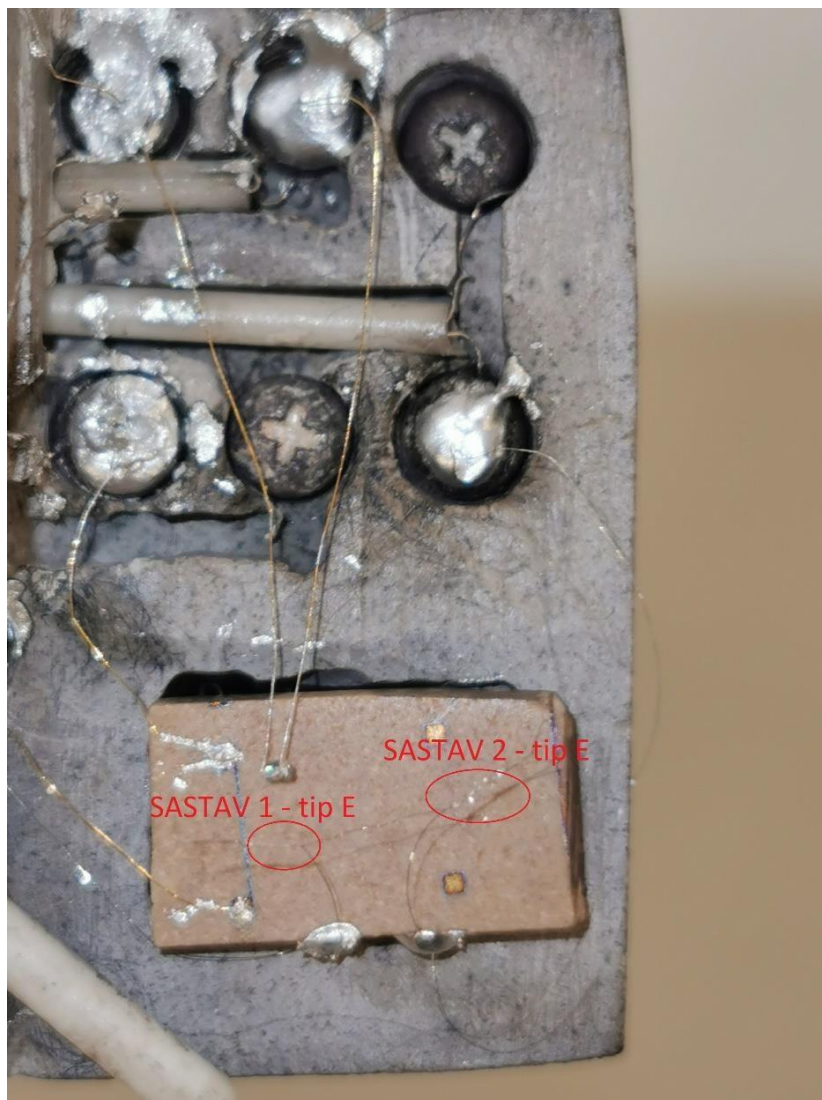
Slika 2.5: Prikaz 2 spojena termočlanka E tipa prilikom montaže eksperimenta. Fotografirano na PMFST-u
