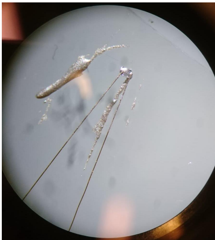
Slika 2.16 (b): Uzorak anataze za mjerenje termostruje metodom dva kontakta. Fotografirano u laboratoriju PMFST-a
