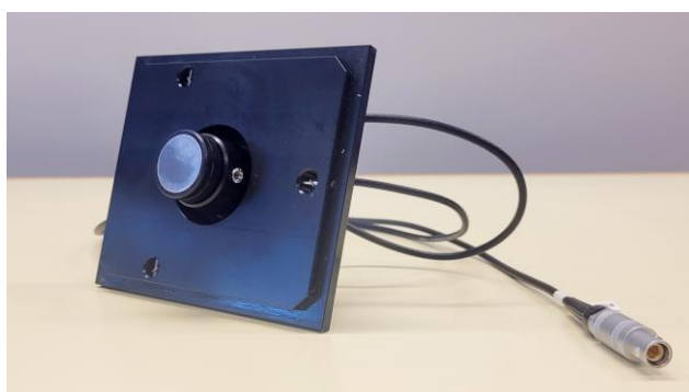
Slika 5. Ultrazvučna sonda povezana s poklopcem spremnika za uzorak.
