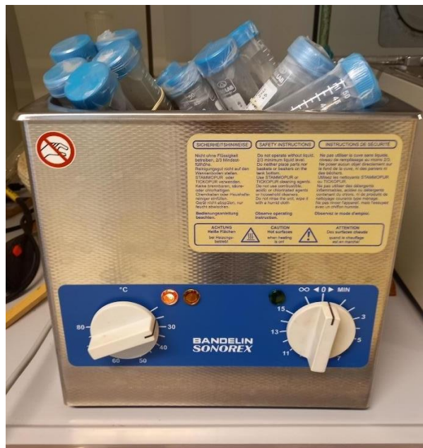
Slika 19. Ultrazvučna ekstrakcija (UAE) (foto: Katarina Bačić)
