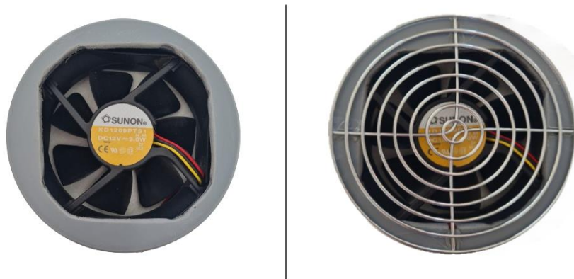
Slika 12 Spajanje poklopca cijevi s ventilatorom i zaštitnom rešetkom
