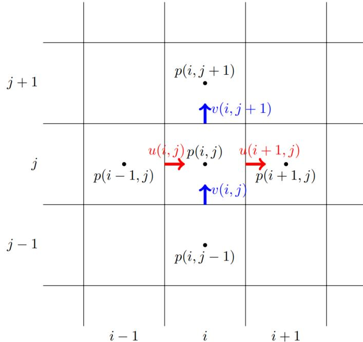
**Slika 5:** Brzine i tlakovi (na slici označeni s  $p$ ) korištene za diskretizaciju jednadžbe (2.22) u koordinatama  $(i,j)$ . (Slika preuzeta iz [6])
