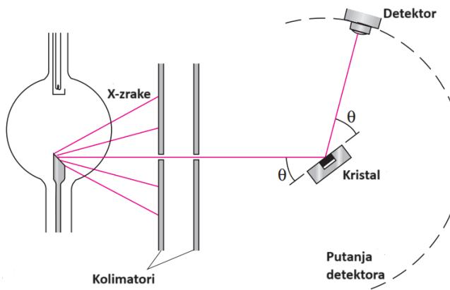
**Slika 3.2:** Rendgenski spektrometar koji koristi metodu skenirajuće difraktometrije za obavljanje mjerena (slika preuzeta iz [1]; engleski tekst na izvornoj slici preveden je na hrvatski)
