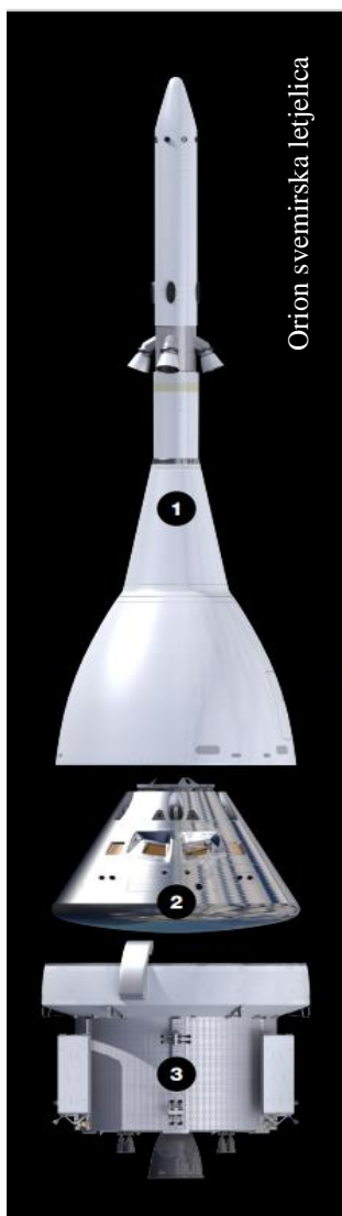
Slika 2. Slika prikazuje svemirsku letjelicu Orion i njena tri glavna dijela; pod brojem jedan: sustav za prekid lansiranja, pod brojem dva: modul za posadu, pod brojem tri: servisni modul (slika preuzeta s https://www.nasa.gov [12]).
