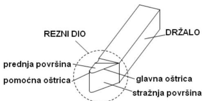
Slika 7 osnovni elementi alata za rezanje [14]
