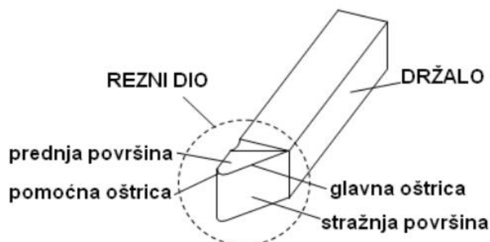
Slika 7 osnovni elementi alata za rezanje [14]
