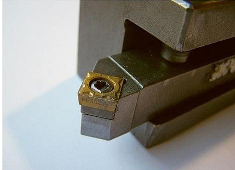
*Slika 8 Tokarski nož za grubu obradu [4]*
