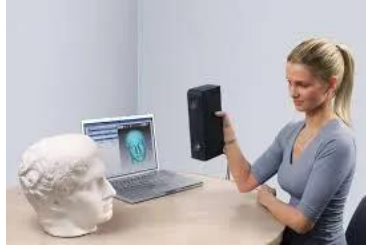
Slika 2.7 - Modularni svjetlosni skener [21]
