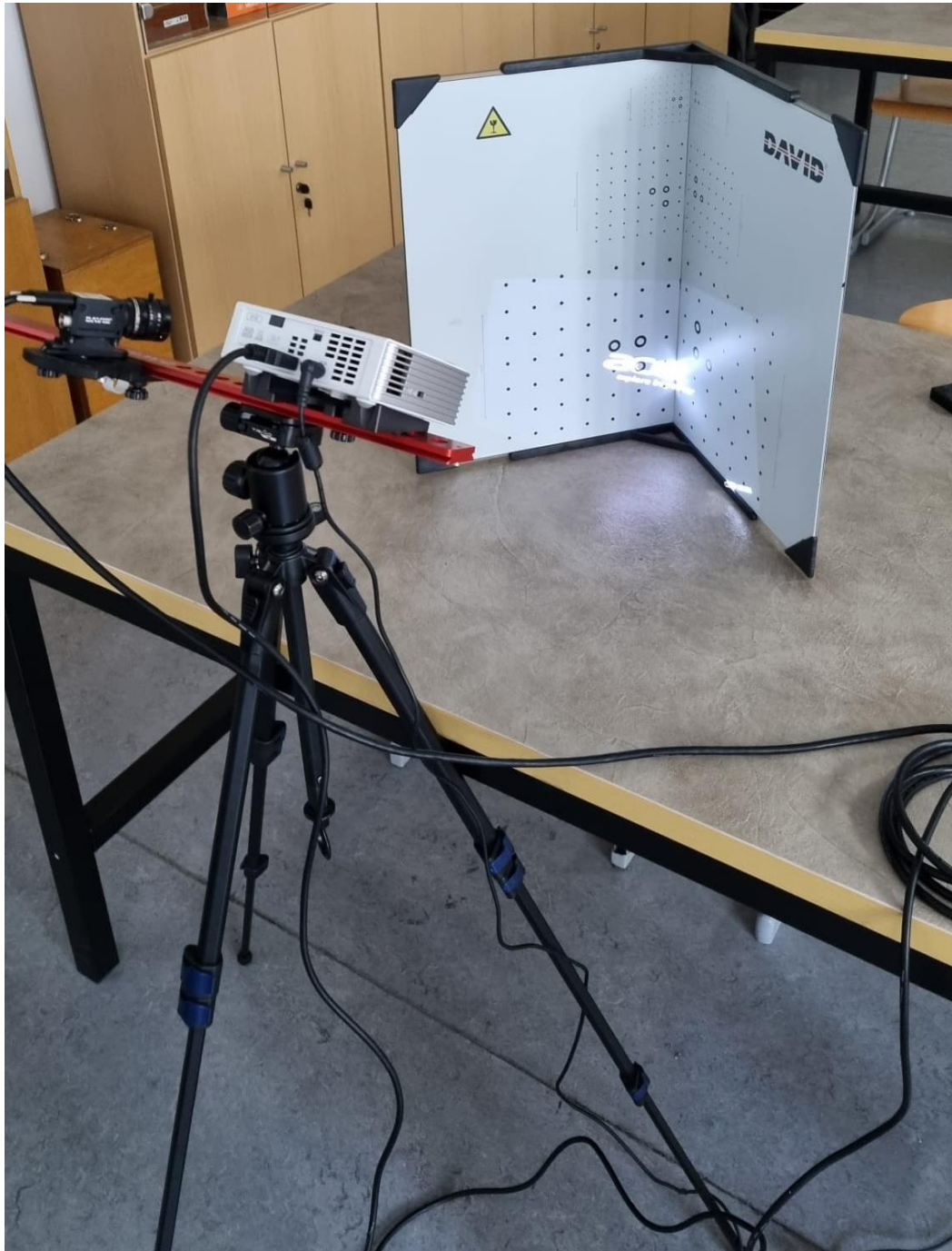
Slika 4.3 – Ploče za kalibraciju
