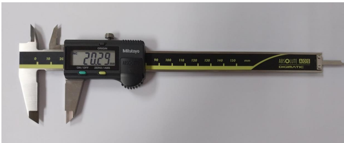
Slika 5.1 – Digitalno pomično mjerilo
