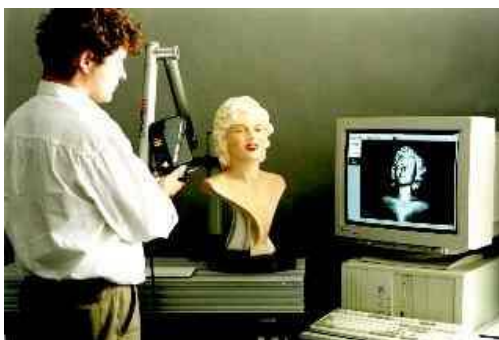
Slika 2.2 – Skeniranje ModelMarker skenerom [8]
