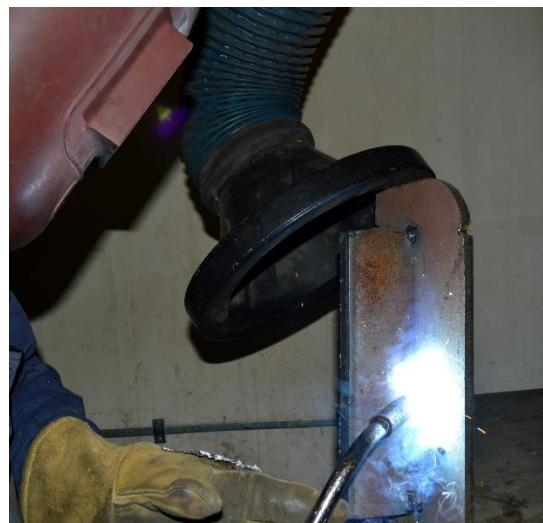
Slika 3: Zavarivanje MAG postupkom[8]
