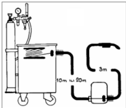
Slika 10: Tandemski sustav za dovođenje žice[12]
