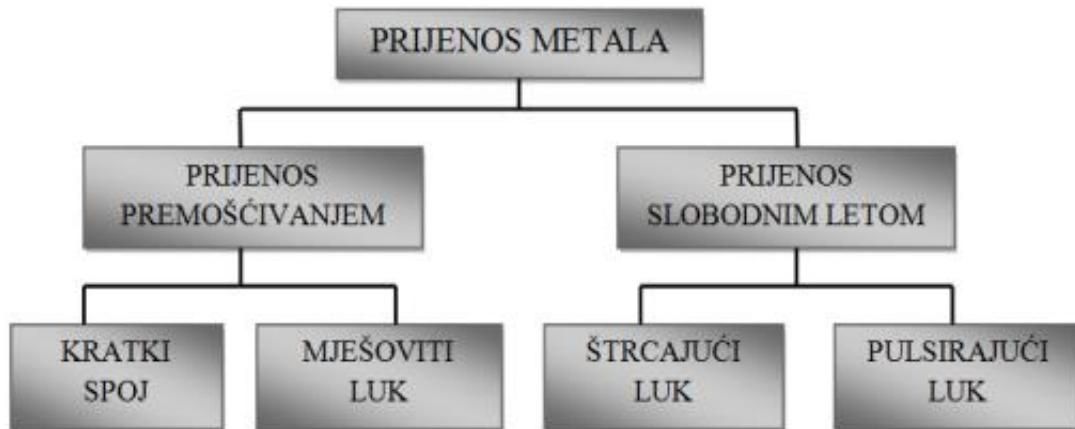
Slika 13: Shema mehanizma za prijenos metala kod MAG zavarivanje[4]
