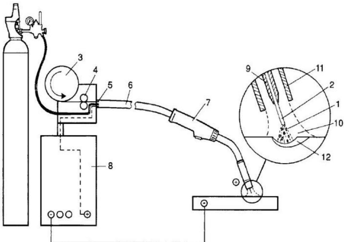
Slika 4: Shema elektrolučnog zavarivanja taljivom metalnom elektrodom u zaštitnoj atmosferi s aktivnim plinovima (CO<sub>2</sub> i mješavine)[10]
