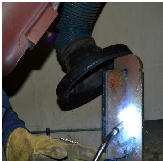
Slika 3: Zavarivanje MAG postupkom[8]
