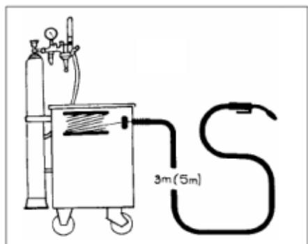
Slika 8: Kabinski sustav za dovođenje žice[12]
