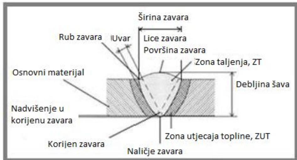
Slika 2: Dijelovi zavara[2]
