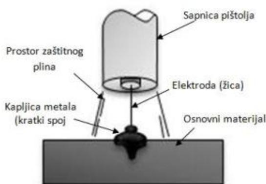
Slika 14: Shema prijenosa metala kratkim spojem[4]
