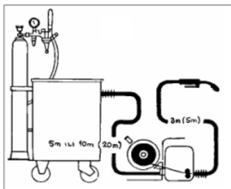
Slika 9: Univerzalni sustav za dovođenje žice[12]
