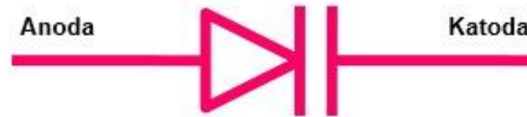
Slika 4.12 Simbol varikap diode [34]
