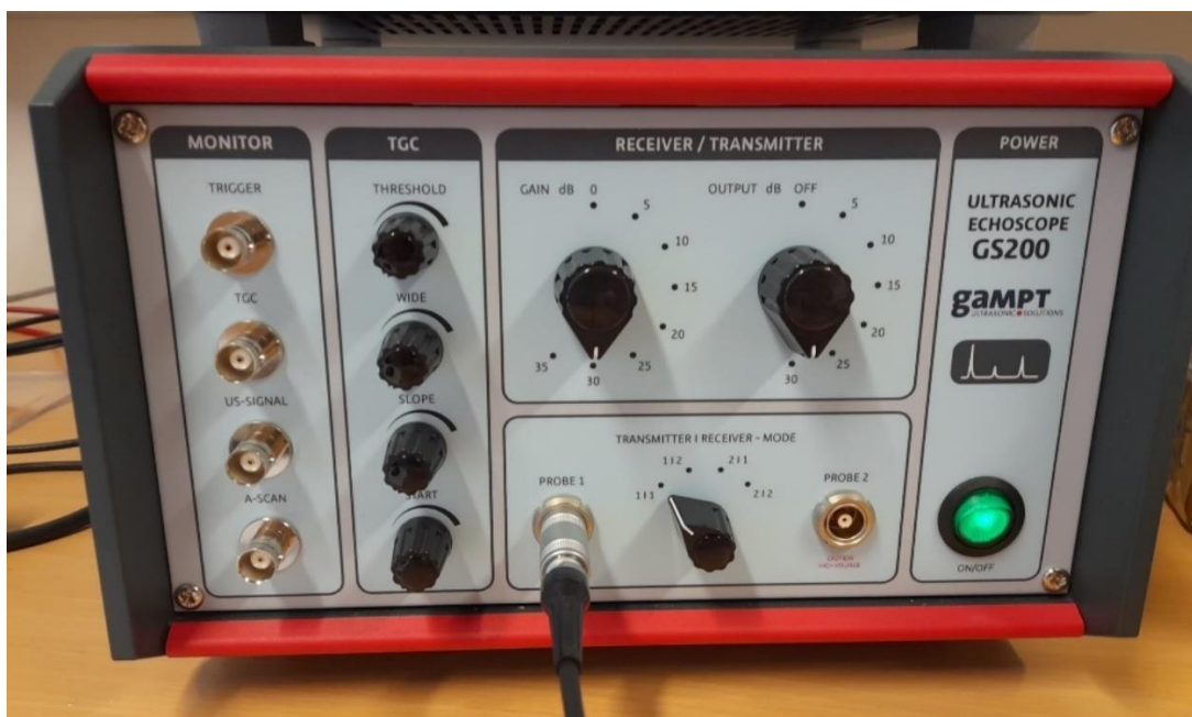
Slika 3. Upravljačka ploča ultrazvučnog ehoskopa GS2000
