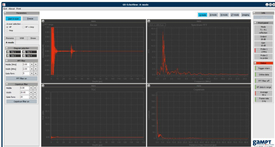
Slika 4. Slika prikazuje pokrenut program pri mjerenu. Amplituda reflektiranog ultrazvučnog vala se očitava iz gornjeg lijevog grafa.
