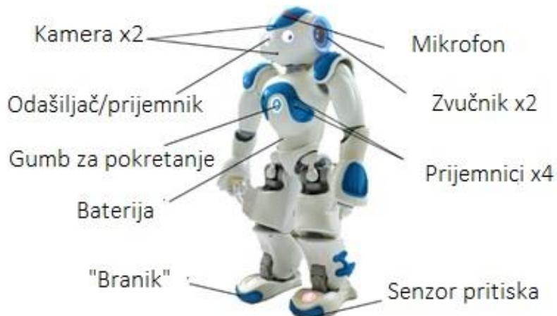
*Slika 3.10 Nao robot- dijelovi*
