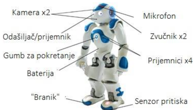
Slika 3.10 Nao robot- dijelovi
