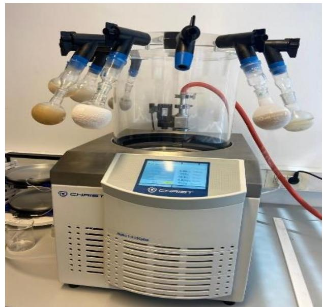
**Slika 14.** Liofilizacija (izvor :vlastita izrada)
