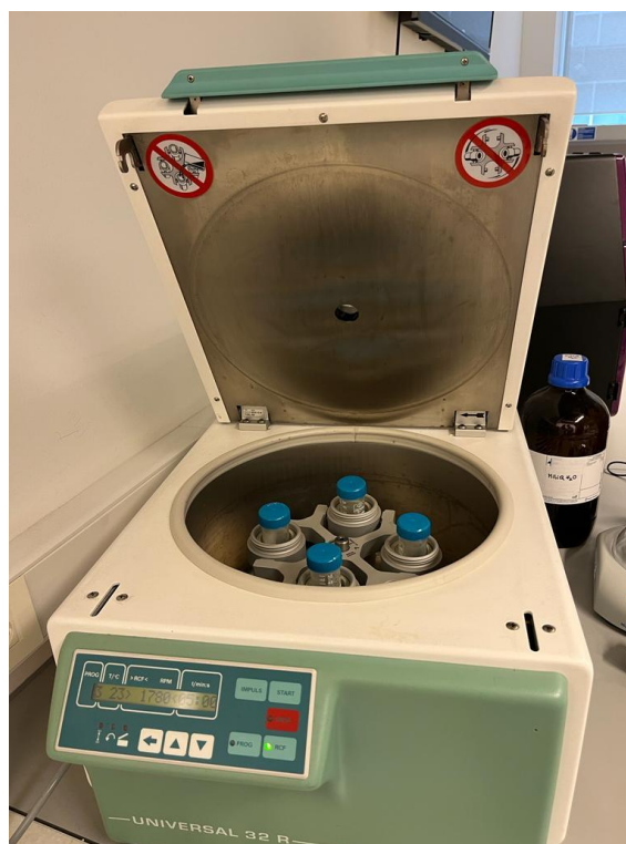
Slika 9. Centrifugiranje nakon ekstrakcije (izvor: vlastita izrada)
