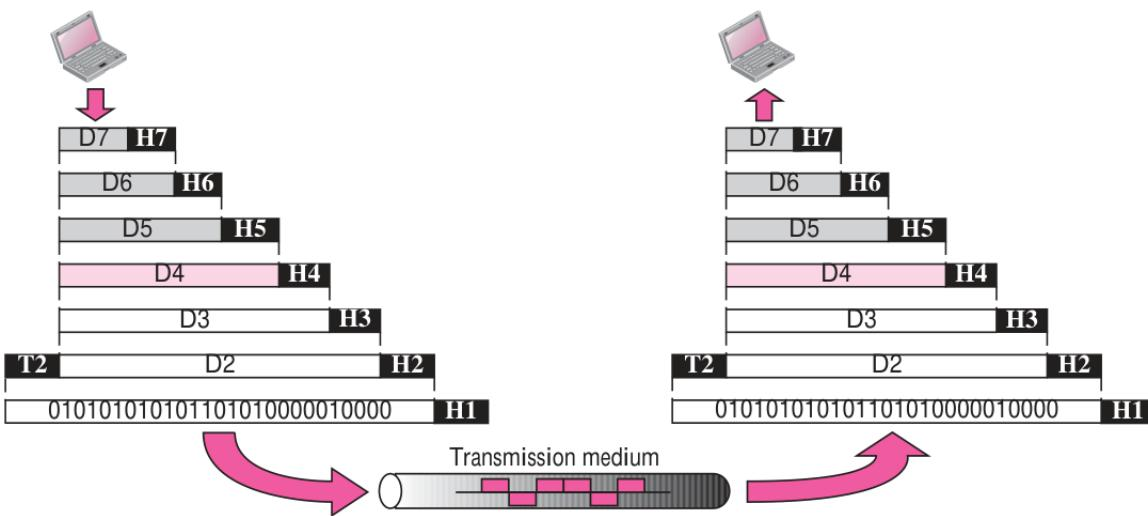
*Slika 23. Razmjena podataka korištenjem OSI modela (preuzeto iz [2])*
