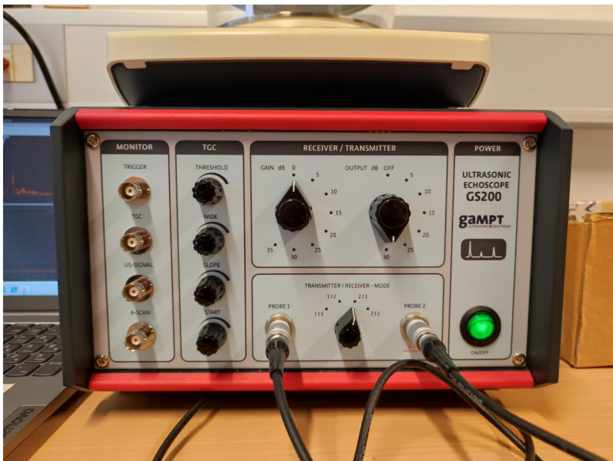
Slika 3. Na slici je prikazan ultrazvučni ehoskop GS200. Sa prednje strane se nalaze kontrolni elementi uređaja.
