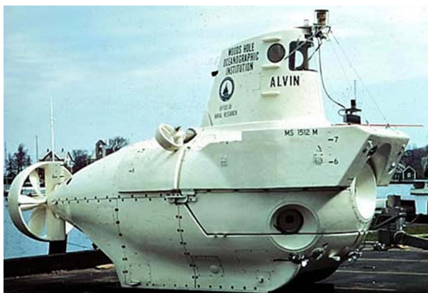
Slika 7. Alvin je prva svjetska dubokomorska ronilica s posadom. Osim što je sudjelovala u otkriću hidrotermalnih izvora, ova ronilica je pomogla u identifikaciji preko 300 morskih životinjskih vrsta.
