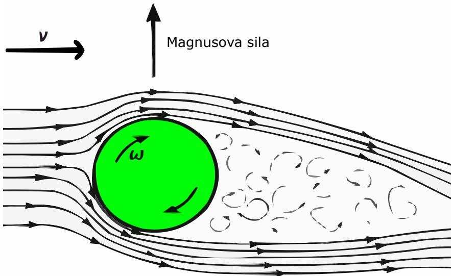
**Slika 6:** Skica pojednostavljenog strujanja zraka oko lopte. Zbog različitih brzina zraka na dvije strane lope javlja se sila okomita na gibanje zraka i kutnu brzinu lope — Magnusova sila (slika preuzeta s [20]).
