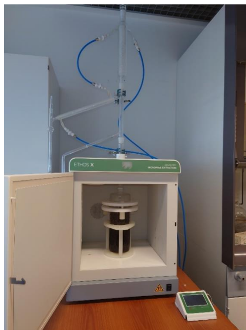
Slika 10. Unutrašnjost uređaja za mikrovalnu ekstrakciju
