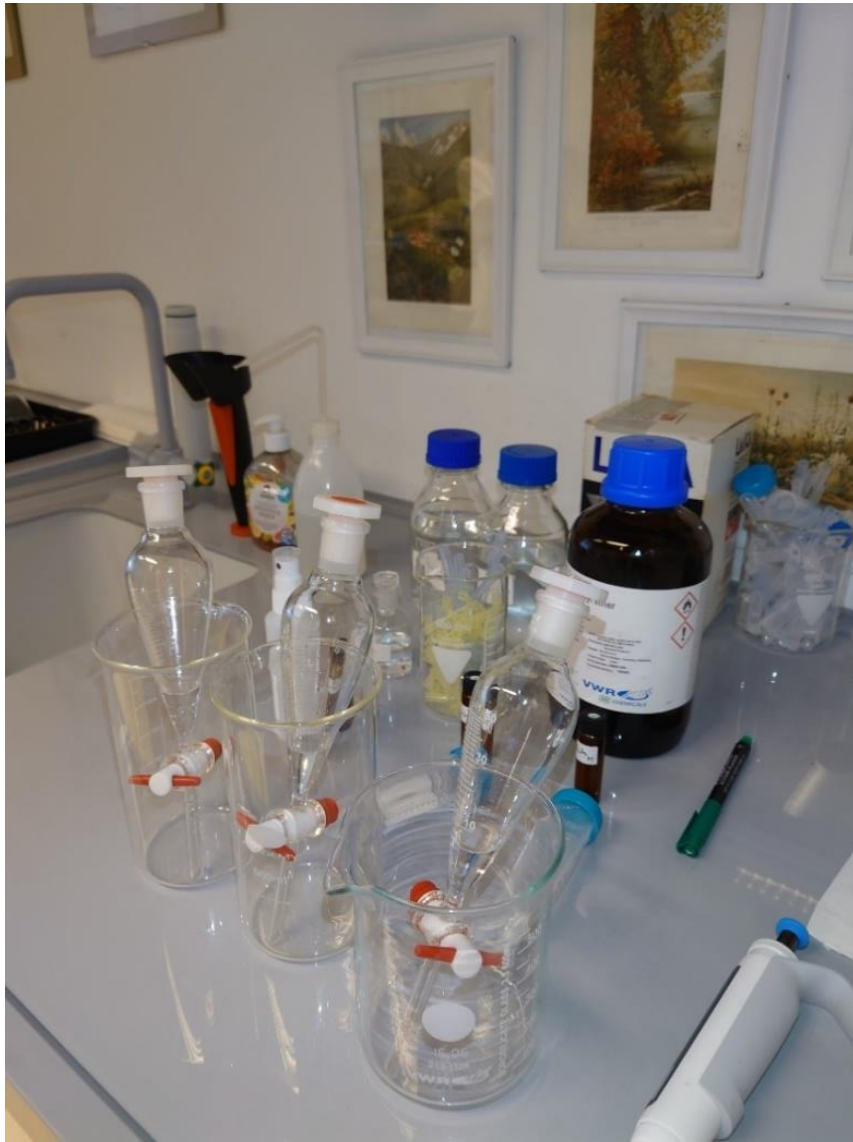
Slika 12 . Lijevak za odjeljivanje sa hidrolatom i vodenim slojem
