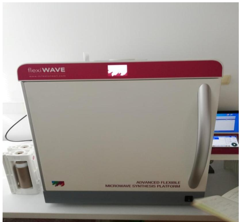
**Slika 4.** Mikrovalna peć korištena za sintezu
