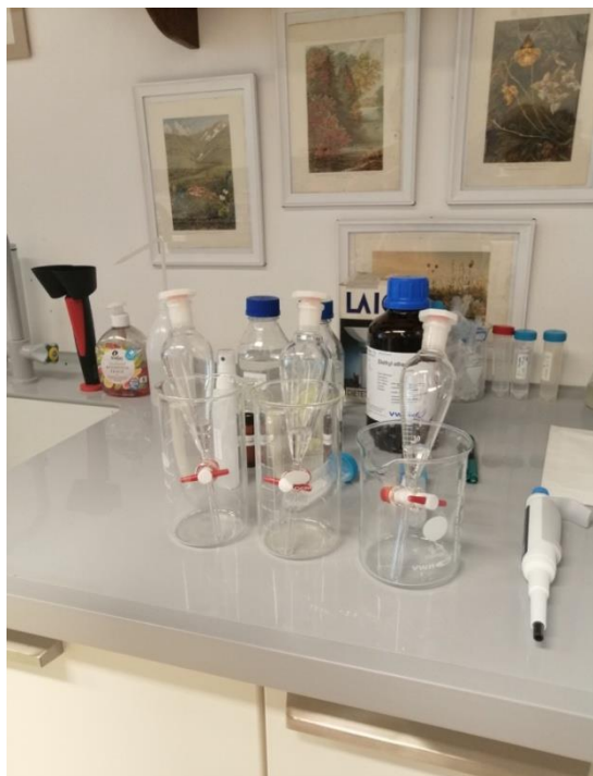
Slika 11. Ekstrakcija uzoraka pomoću lijevka za odjeljivanje
