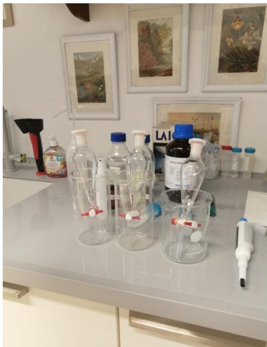
Slika 11. Ekstrakcija uzoraka pomoću lijevka za odjeljivanje
