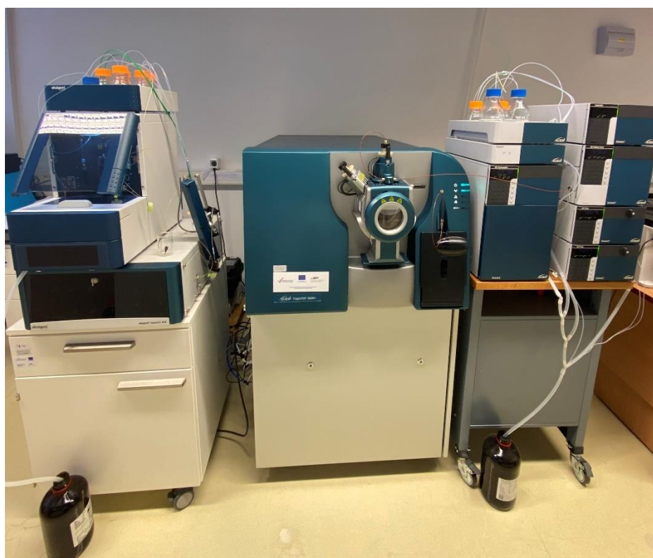
Slika 12. - Maseni spektrometar (SCIEX - Triple TOF 6600+) uparen s tekućinskom kromatografijom (SCIEX – ExionLC)
