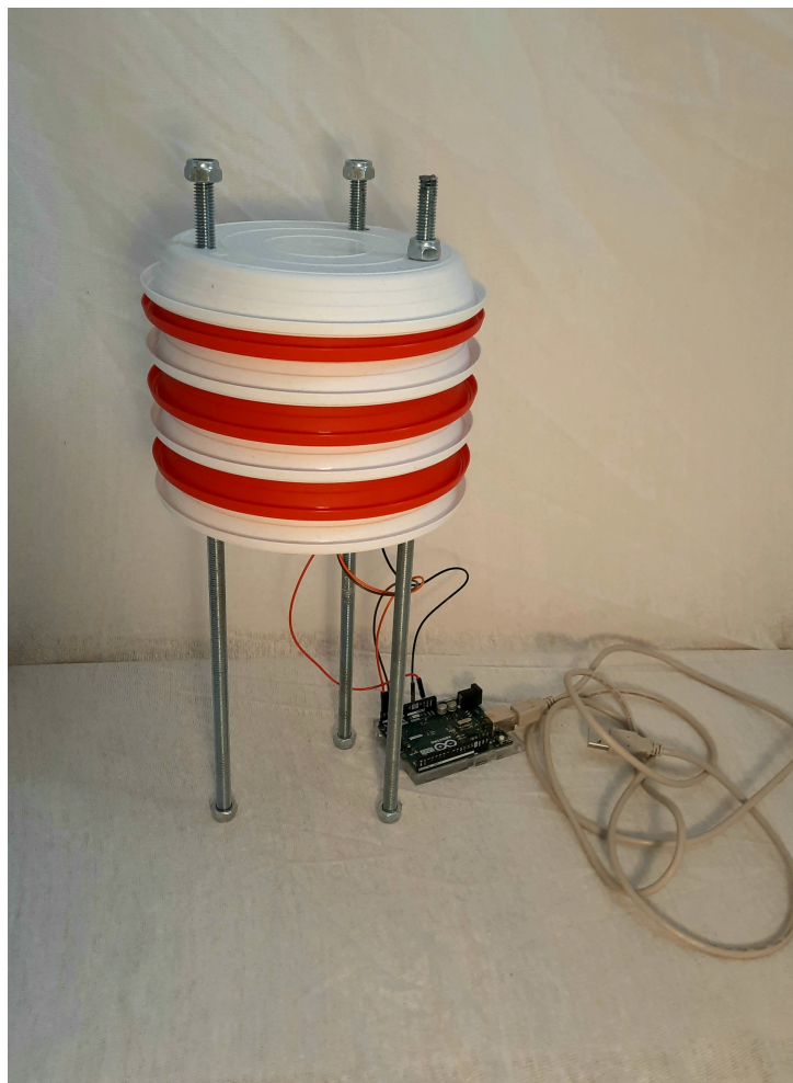
Slika 8: Završeno kućište meteorološke postaje (izvor: autor)
