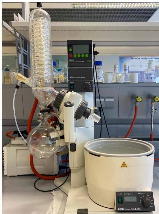
Slika 23. Büchi Rotavapor R-200 - uređaj za uparavanje
