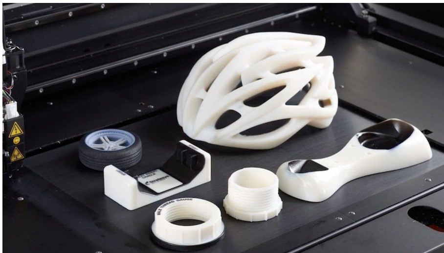
Slika 2.7. Modeli izrađeni PolyJet tehnologijom [11]
