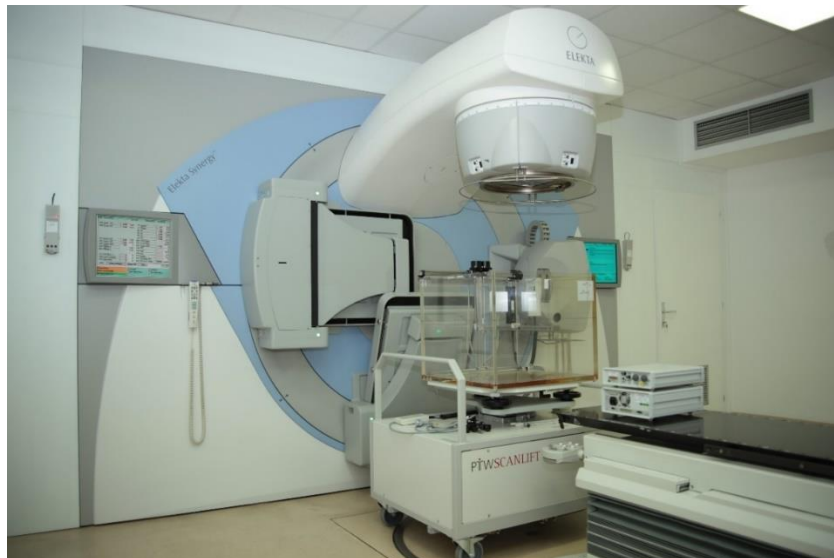
Slika 24. Postav akceleratora i fantomskog sustava za testiranje fotonskih i elektronskih snopova koji se nalaze na Klinici za onkologiju i radioterapiju SKB Split.
