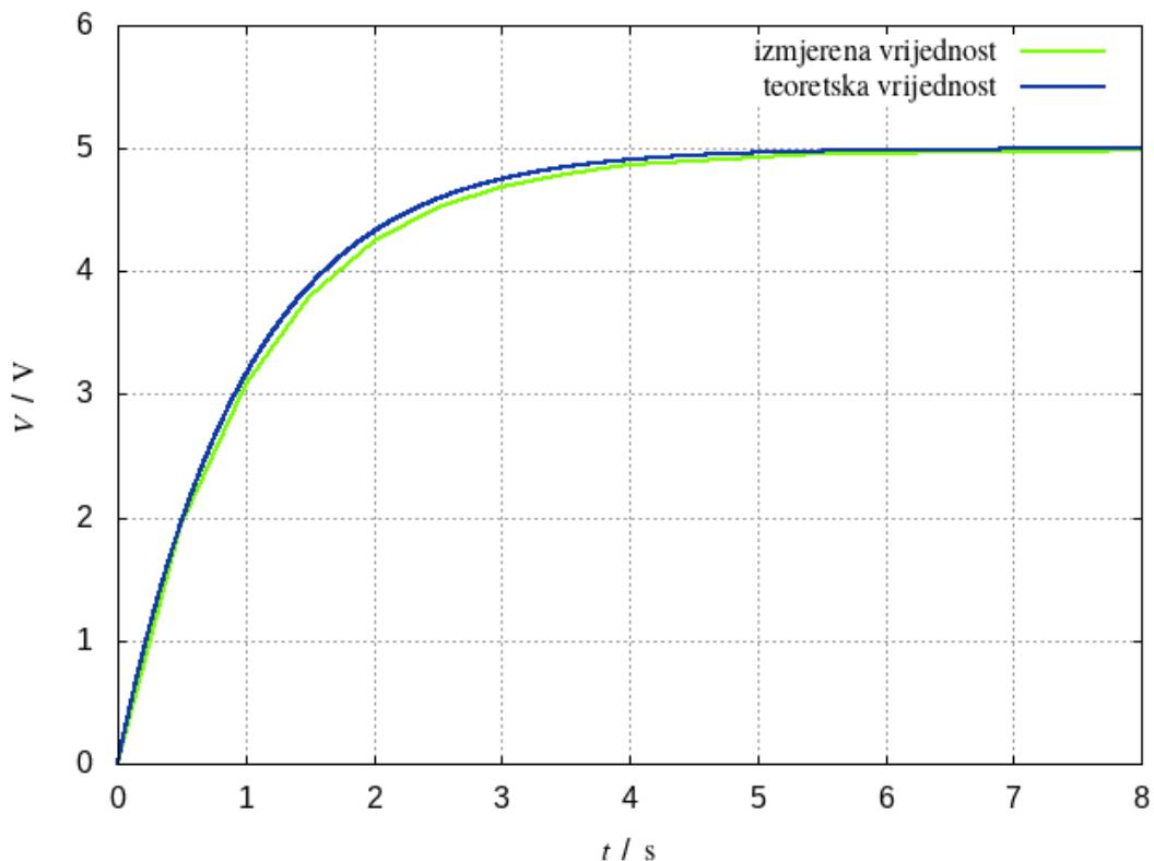
**Slika 23:** Ovisnost napona o vremenu pri punjenju kondenzatora - usporedba mjerjenja i teoretskog predviđanja (2.12) za kondenzator kapaciteta  $100 \mu\text{F}$  i otpornik od  $10 \text{k}\Omega$
