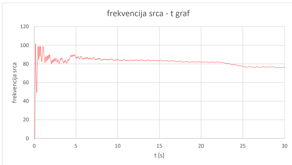
Graf 3. Ovisnost promjene frekvencije srca (y-os) o vremenu (x-os) za izvor svjetlosti crvene diode. Konačna vrijednost brzine otkucaja s grafa je 76,41 otkucaj u minuti. Mobilni uređaj je izmjerio 79 otkucaja u minuti.
