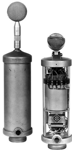
**Slika 2 Prvi kondenzatorski mikrofon, tzv. Neumannova bočica**
