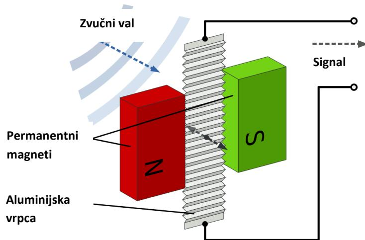
**Slika 7 Prikaz rada elektrodinamičkog mikrofona s vrpcom**
