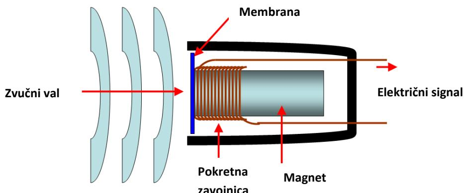
Slika 6 Prikaz rada elektrodinamičkog mikrofona s titrajnom zavojnicom
