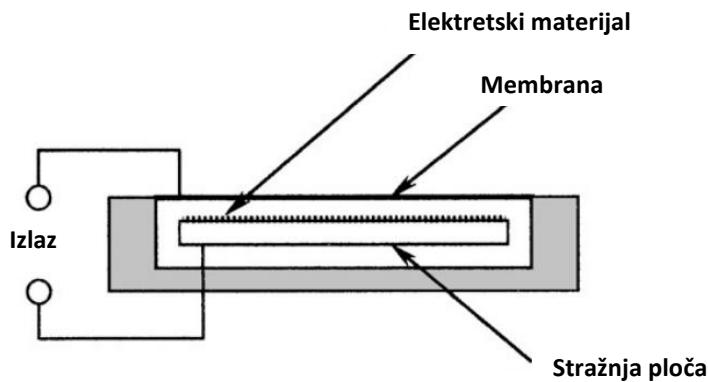
Slika 5 Presjek kapsule kondenzatora sa elektretskom stražnjom pločom
