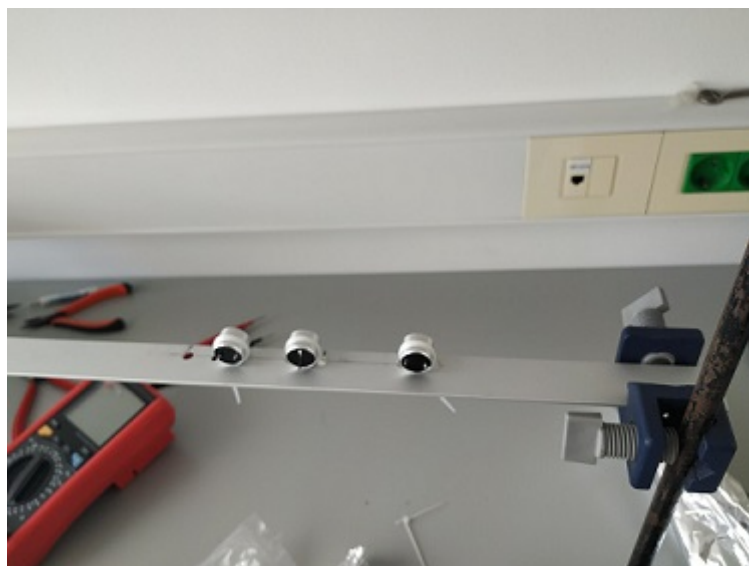
Slika 18: Prijemnici i odašiljač na metalnoj letvici potrebni za traženje žarišne točke zrcala.
